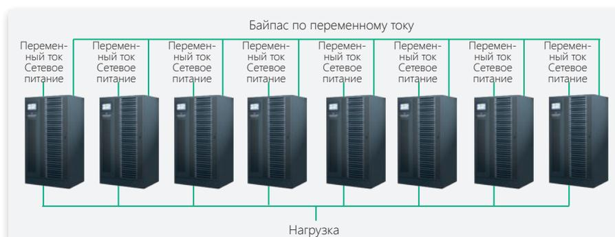
Распределенная параллельная конфигурация Liebert 80-NET с 8 ИБП, подключенными параллельно.
