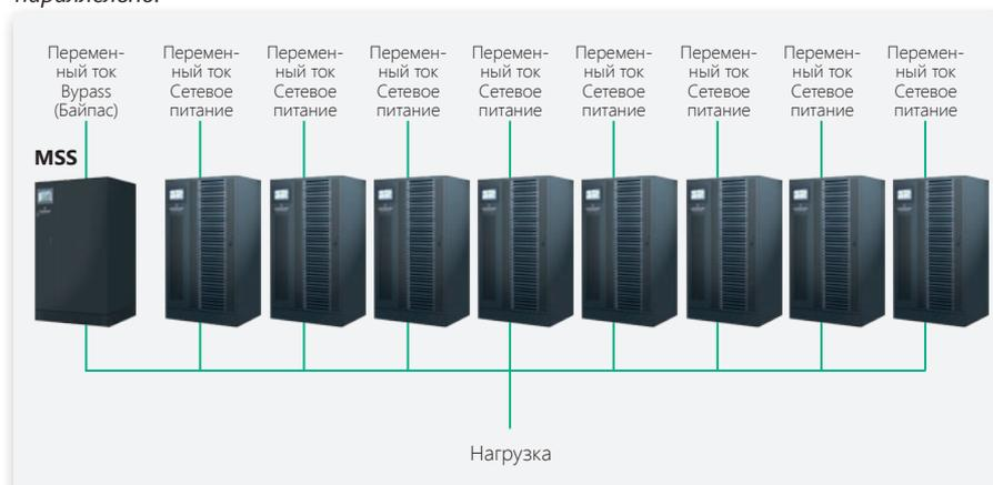
Централизованная параллельная конфигурация Liebert 80-NET, с MSS плюс 8 блоков ИБП, соединенных параллельно.
